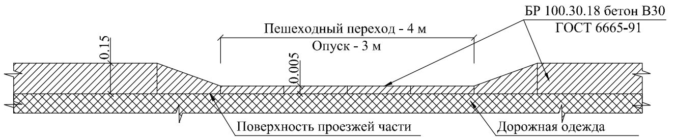
Устройство бортового камня на пешеходных переходах и опусках
